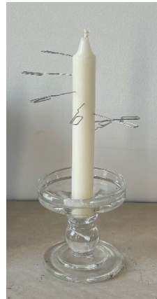
Abbildung 2: Die Büroklammern werden aufgebogen und leicht versetzt mit gleichem Abstand in die Kerze gesteckt. Bild: Forscherstation
